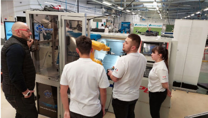
Trois étudiants testent leur programme sur une cellule robotisée de chargement-déchargement de machine-outil.
